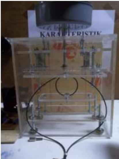
Gambar 1 Sistem alat yang digunakan untuk analisa macrobending
